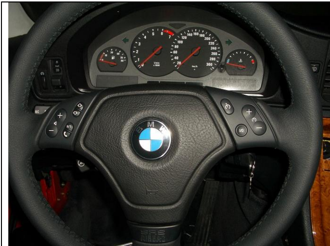
Abbildung 3: E46 Sportlenkrad im M73
